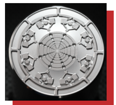
Moule avec micro cavités/canaux, réalisé par laser femtoseconde (aucun post process)
